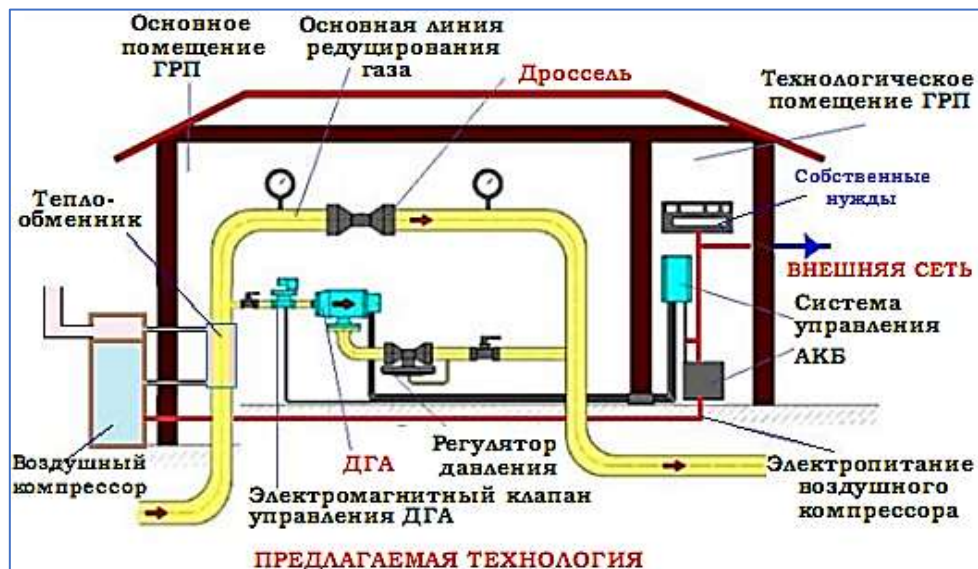
Рис.3. Предлагаемая технология редуцирования природного газа на ГРП (ГРС)
