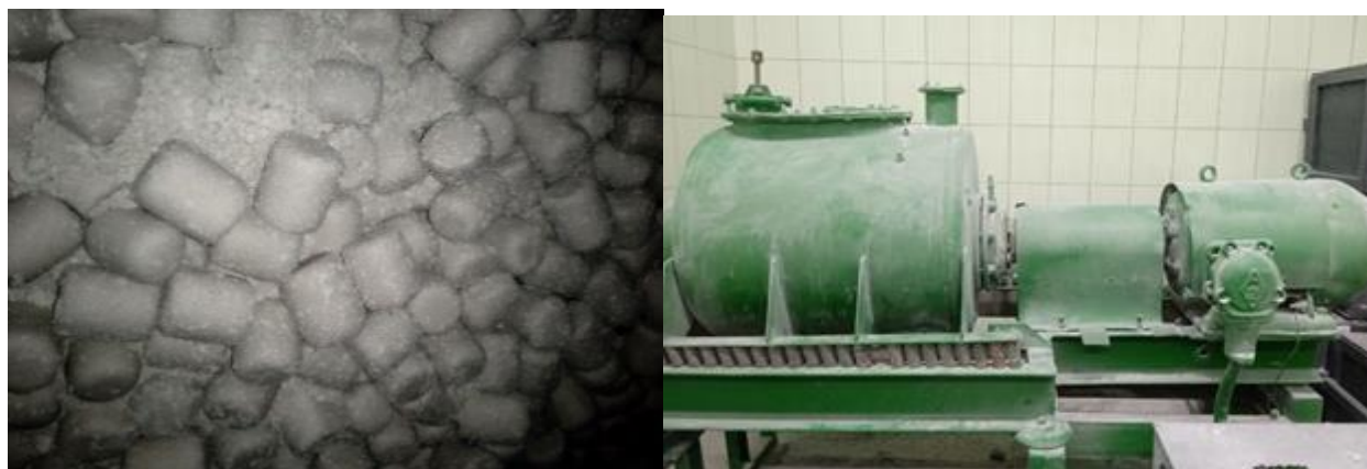
Рисунок 1 – Установка для подрібнення азбесту: а – доломітові шари з азбестом; б – вібромлин для азбесту
