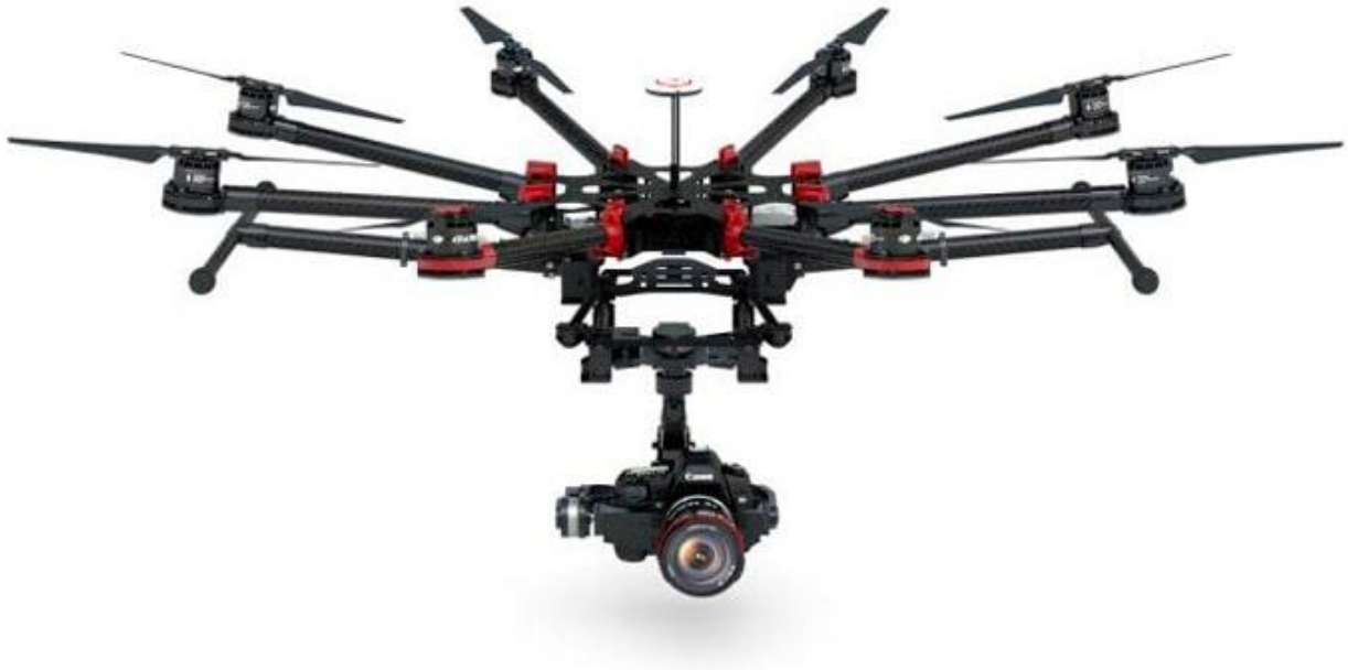
Зображення 5. Приклад дрона з системою підвісу під фотокамеру.
